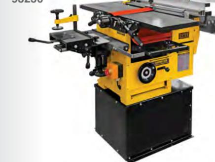
Функции станка: распиловка, строгание, рейсмусование, сверление, фрезерование насадными и концевыми фрезами. Фрезерная головка и фрезерный патрон в комплекте. В режиме сверления заготовка крепится на рабочий стол, перемещаемый по трем осям. При распиловке используется подвижная каретка с прижимной струбциной и транспортным упором. Отключаемая автоподача рейсмуса. Нижний рабочий стол имеет два удлинителя. Предусмотрено подключение пылесоса.
