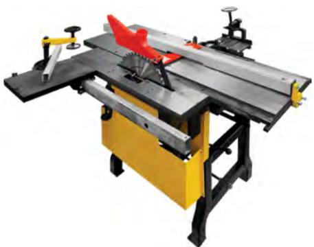
Функции станка: распиловка, строгание, рейсмусование, сверлильно-долбежные операции, выборка пазов и снятие фасок насадными фрезами, заточка строгальных ножей. В режиме сверления заготовка крепится на рабочий стол, перемещаемый по трем осям. При распиловке используется подвижная каретка с прижимной струбциной и транспортным упором.
