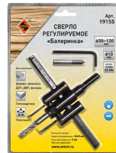
Сверло регулируемое «Балеринка» предназначено для высверливания круговых отверстий больших диаметров (30 - 120 мм) в таких материалах как ламинат, ДСП, фанера, дерево, ДВП, гипсокартон, пластик и др. В комплекте с «Балеринкой» идет шестигранный ключ для регулировки положения резов относительно направляющего сверла и керн центрирующий. Материал резов – сталь 65 Мп.
