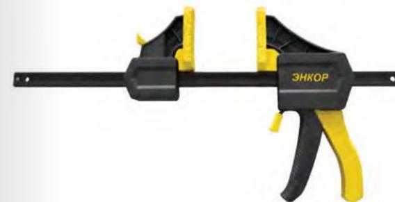
Струбцина ручная пистолетная применяется для быстрого захвата или разжатия деталей. Корпус из нейлона, армированного фиброглассом, и стальной стержень обеспечивают высокий рабочий ресурс. Мягкие накладки на губки для бережного обращения с поверхностью деталей.
