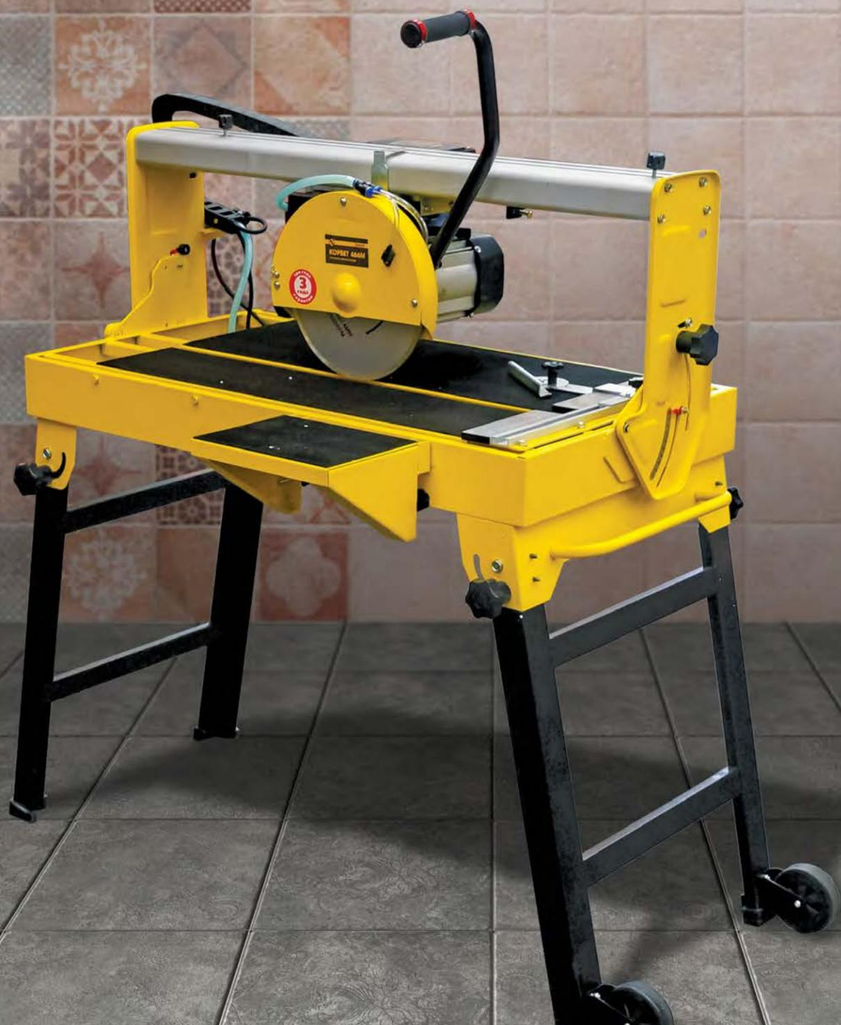
**ПЛИТКОРЕЗЫ****ПЛИТКОРЕЗЫ ЭЛЕКТРИЧЕСКИЕ ДИСКОВЫЕ**
