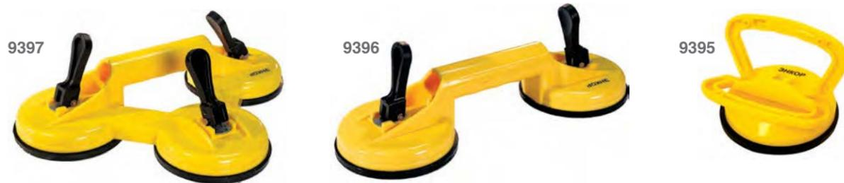
АВС пластиковый корпус. Резиновое нескользящее основание прочно фиксируется на предмете по вакуумному принципу, что позволяет поднимать груз весом от 40/80/140 кг соответственно.
