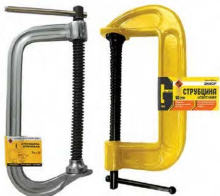
Струбцины G-образные обеспечивают надежную фиксацию различных деталей и заготовок. Прочный винтовой механизм имеет трапециевидальную однозаходную резьбу. Ассортимент представлен коваными струбцинами, изготовленными из конструкционной стали и усиленными струбцинами, изготовленными из высокопрочного чугуна.
