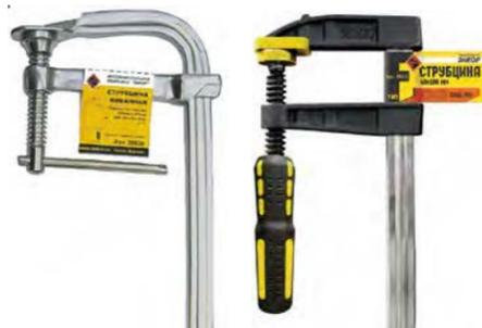
Струбцины F-образные являются надежным зажимным инструментом и состоят из рамы и подвижной части с винтовым зажимом. Винт зажима имеет трапециевидальную однозаходную резьбу. Накладки на губках защищают обрабатываемые предметы от повреждений. Обеспечивают зажим по всей длине штанги.
