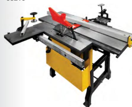
Функции станка: распиловка, строгание, рейсмусование, сверлильно-долбежные операции, выборка пазов и снятие фасок насадными фрезами, заточка строгальных ножей. В режиме сверления заготовка крепится на рабочий стол, перемещаемый по трем осям. При распиловке используется подвижная каретка с прижимной струбциной и транспортным упором.
