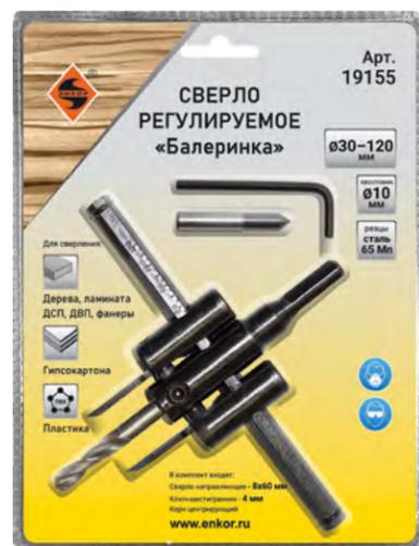
Сверло регулируемое «Балеринка» предназначено для высверливания круглых отверстий больших диаметров (30 - 120 мм) в таких материалах как ламинат, ДСП, фанера, дерево, ДВП, гипсокартон, пластик и др. В комплекте с «Балеринкой» идет шестигранный ключ для регулировки положения резцов относительно направляющего сверла и керн центрирующий. Материал резцов – сталь 65 Mn.
