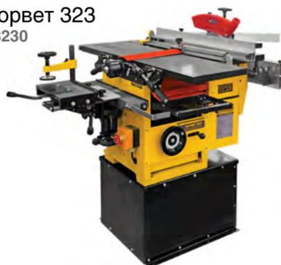
Функции станка: распиловка, строгание, рейсмусование, сверление, фрезерование насадными и концевыми фрезами. Фрезерная головка и фрезерный патрон в комплекте. В режиме сверления заготовка крепится на рабочий стол, перемещаемый по трем осям. При распиловке используется подвижная каретка с прижимной струбциной и транспортным упором. Отключаемая автоподача рейсмуса. Нижний рабочий стол имеет два удлинителя. Предусмотрено подключение пылесоса.
