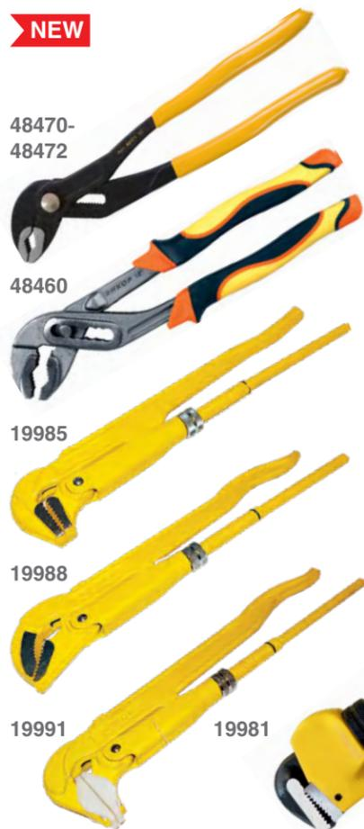
Газовые ключи и сантехнические клещи серии «Сантехник» изготовлены из кованой хромованадиевой стали. Конструкция рукоятки обеспечивает оптимальный перенос усилия. Закалённые зубья наклонены против направления вращения, что предотвращает проскальзывание.
