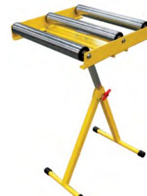
Роликовые опоры используются для работы совместно со станками различных типов и предназначены для поддержания длинных заготовок и различных деталей при их подаче на станок, а также после выхода готовых изделий.
