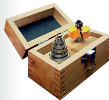
Фреза арт. 9303 поставляется в наборе арт. 10625 с комплектом подшипников. Данный набор позволяет путем смены подшипника получать различную глубину выборки фальца по кромкам различной кривизны.
