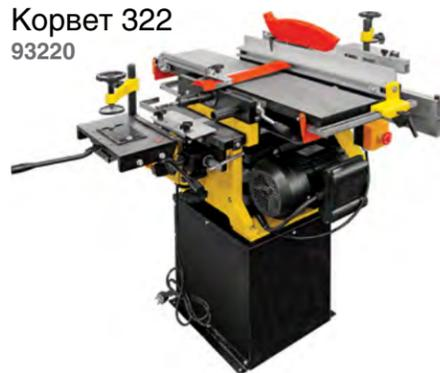
Функции станка: распиловка, строгание, рейсмусование, сверление, фрезерование насадными и концевыми фрезами. Фрезерная головка и фрезерный патрон в комплекте. В режиме сверления заготовка крепится на рабочий стол, перемещаемый по трем осям. При распиловке используется подвижная каретка с прижимной струбциной и транспортным упором. Отключаемая автоподача рейсмуса. Нижний рабочий стол имеет два удлинителя. Предусмотрено подключение пылесоса.
