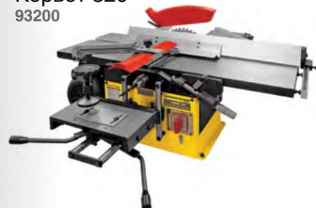
Функции станка: распиловка, строгание, сверление. В режиме сверления заготовка крепится на рабочий стол, перемещаемый по трем осям. При распиловке используется подвижная каретка с прижимной струбциной и транспортным упором. Предусмотрено подключение пылесоса.
